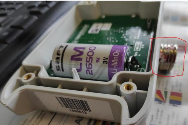
Magnet auf der Seite (rechts) platzieren und unterhalb der Batterie ca. 3-5 Sekunden halten bis in der Mitte das LED (Orange) leuchtet. Bitte beachten, dass der Magnet genug stark ist. Grundsätzlich muss der LPN Tracker für den Reset nicht zwingend aufgeschraubt werden. Wir empfehlen es allerdings, damit geprüft werden kann ob das LED in der Mitte leuchtet und der Reset durchgeführt wird.
